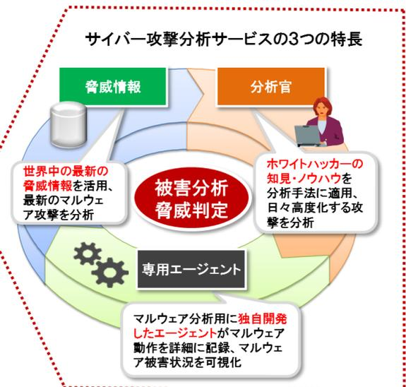
特に「サイバー攻撃分析サービス」では、専用エージェントがマルウェアの詳細な動作ログを取得し、インシデント発生時のマルウェアの侵入経路の特定から、被害状況、感染の拡散状況の把握と分析を行い、被害の低減を支援します。平常時にも、ワールドワイドで展開されている最新の脅威情報を提供し、マルウェアと疑わしきものを早期に特定することができます。
