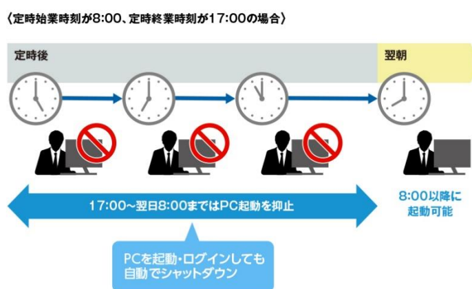
図 1 PC 自動シャットダウンシステムの機能
