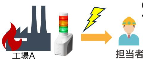
状況が可視化され、異常が発生したときに周囲の作業員がすぐに気づいて対応できるのでトラブルの拡大を防げる
