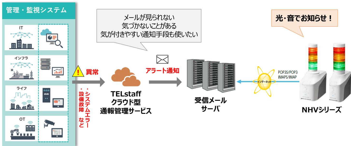
NHVからメールサーバーにアクセスし、検知条件<sup>※1</sup>に合致したメールを受信した際にLED点灯・音声によって知らせることができます。
